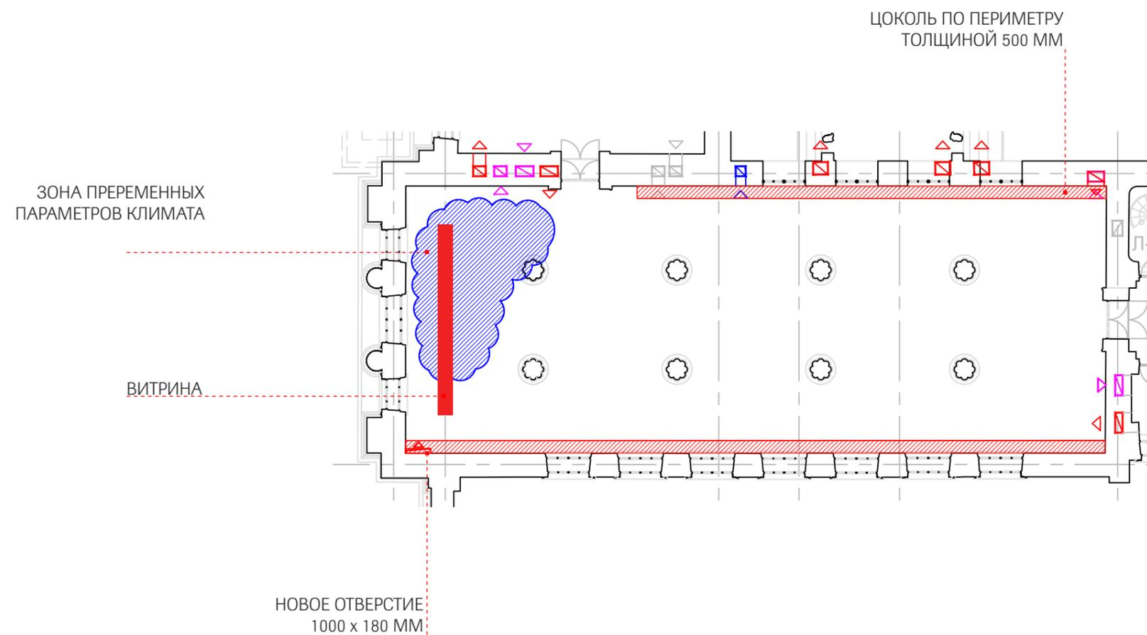
При наличии достаточной площади шахт, в зал поступает необходимое количество воздуха для создания и поддержания требуемых параметров воздуха  $dt=19+2C$ ;  $d\phi=45+5\%$ . Данный воздух требуется равномерно распределить по всему объему рабочей зоны.
